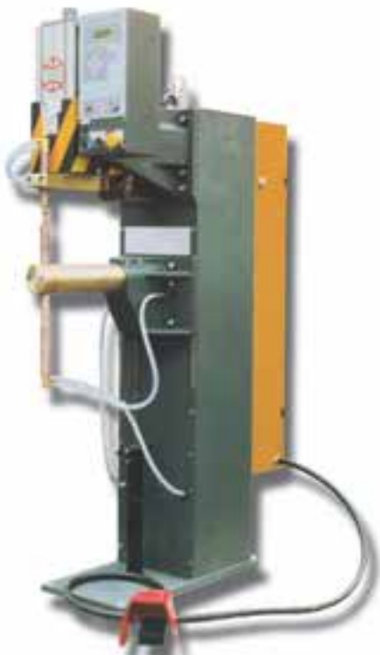
Machine PA avec PE inférieur de 400 mm de type A (porte-électrode supérieur déporté par rapport à l'axe du vérin)
